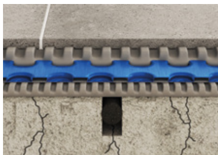
Укладка Mapeguard UM 35 на растрескавшиеся основания
