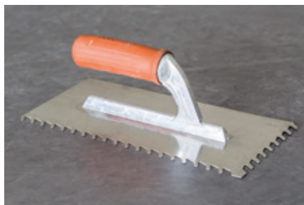
Шпатель со скошенными зубьями для нанесения клея на основание и шпатель с квадратными зубьями для обработки тыльной стороны плитки
